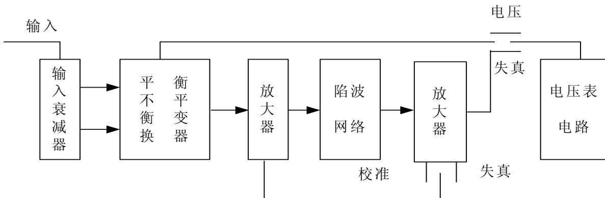
设计中对关键电路和器件采用了特殊的设计和制造工艺，并采用了当代计算机技术与之相结合，程控自动跟踪输入信号的频率、幅度，自动滤谐，全部数据有 LED 数字显示。仪器面板上保留了示波器输出监视插孔，便于使用者直接观察被测信号的波形，特别在失真测量状态，使用者可直接观察到被测信号的失真主要是由哪次谐波形成的及滤谐状态，在小失真信号测量时，可以直接观察到整机的滤谐状态。
