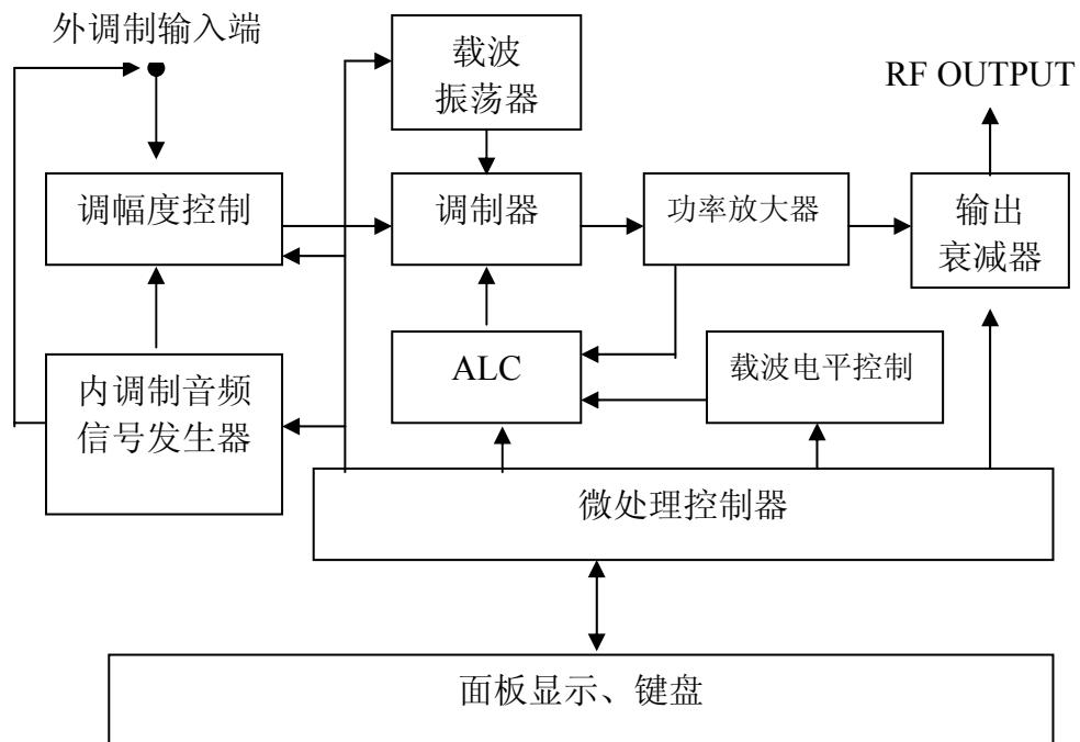
KH1460 型信号发生器主要由载波发生器、调制控制器、功率放大器、输出衰减器、载波电平输出控制器、调幅度控制器、微控制器和键盘扫描、数据显示及电源部分组成。
